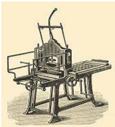
Steindruckhand- oder Kniehebelpresse von Erasmus Sutter, 1839
